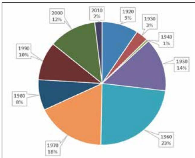
Diagramm Baujahre der Wasserleitungen (Stand 2014)
