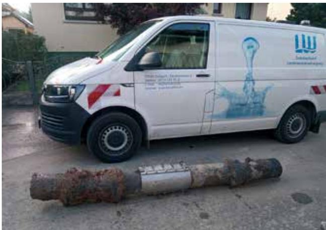
Ausgebautes Teilstück der Wasserleitung mit Rohrbruchschelle
