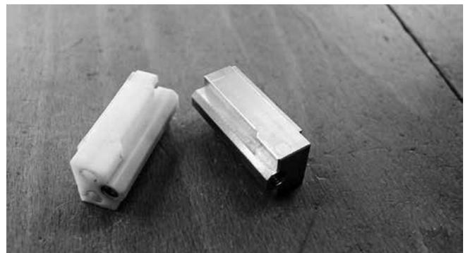
Nach kleinen Optimierungen funktionierte der Antrieb wieder einwandfrei und es wurden anschließend 10 neue Ersatzteile auf der CNC - Fräsmaschine gefertigt.
